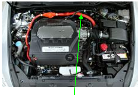
Orange HV Cable.
